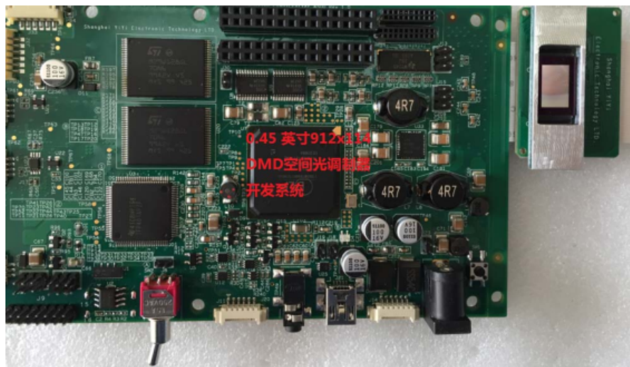
WXGA 0.45" DMD DLPC350 开发系统电路板
